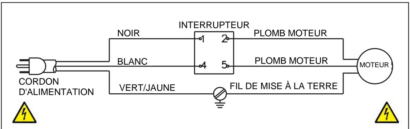
Cet outil est destiné à être utilisé sur un circuit qui a un réceptacle électrique de 120 volts. L'illustration à la page 5 montre le type de 120V, bouchon électrique à 3 fils et réceptacle qui a un conducteur de mise à la terre qui est nécessaire.
