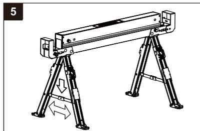
6. Les pieds se règlent par incréments de 1 pouce. Pour étendre, baissez les pieds jusqu'à ce que la serrure soit verrouillée à la position souhaitée. Pour rétracter, appuyez sur le bouton de verrouillage, baissez un peu les pieds, puis faites monter un pied.
