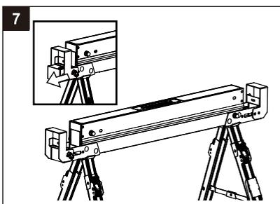
8. Ensemble avec une autre unité jointe correctement par la traverse dans le bras de soutien, une table de travail peut soutenir jusqu'à 2600 lb (1180kg).
