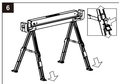
7. Veuillez desserrer le bouton, ajuster les supports à la largeur exigée et resserrer le bouton. L'écart est de 40 mm à 90 mm pour convenir aux tailles différentes des poutres du bois.
