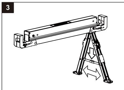
4. Appuyez sur le bouton déclencheur au-dessus de la location étiquetée 'CLOSE 1st' et baissez les pieds.
